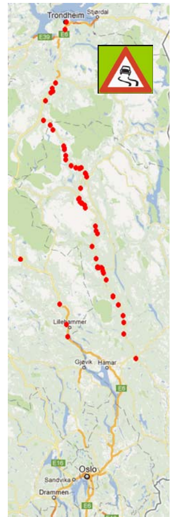
Meldinger om glatt veibane, sendt fra kjøretøyene som deltok i "live"-demonstratoren Oslo - Trondheim. Kartgrunnlag: Google Maps
