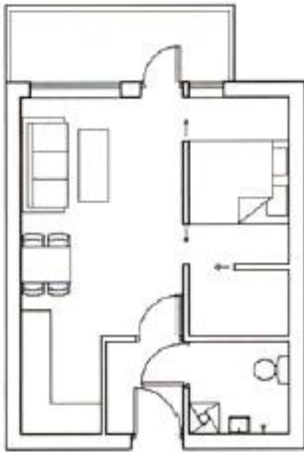
Figur 14. Ensidig orientert, rektangulær løsning på 34,5 m 2 med inngangsdør på bakveggen
