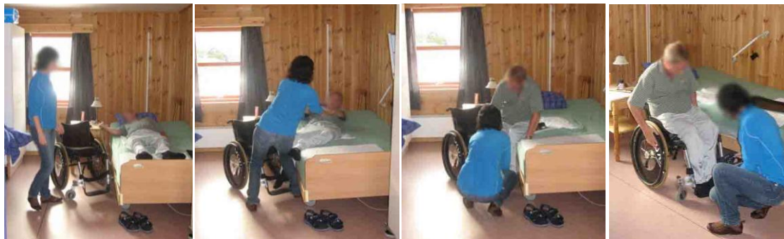
Figur 5. Illustrasjon av plassbehov ved seng hos en rullestolbruker som trenger hjelp til forflytning mellom seng og rullestol, men som ellers stort sett er selvhjulpen. Beboeren har sykeseng med utvendige mål som er ca 100 mm bredere og 50-100 mm lenger enn vanlige senger. Merk at plassbehovet som følger av rullestolen også medfører plassbehov ved sengeenden, her illustrert med et par sandaler og plassen som assistenten legger beslag på i bildene lengst til høyre.
