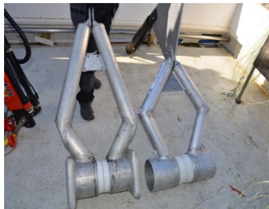
Brinchmann sin originale gjennomføring til venstre og den første nye versjonen med brems til høyre.
