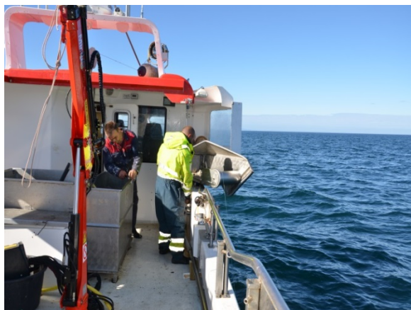
Dorga dras med kveileren og går deretter gjennom et rør som stikker ut bakpå hekken.
