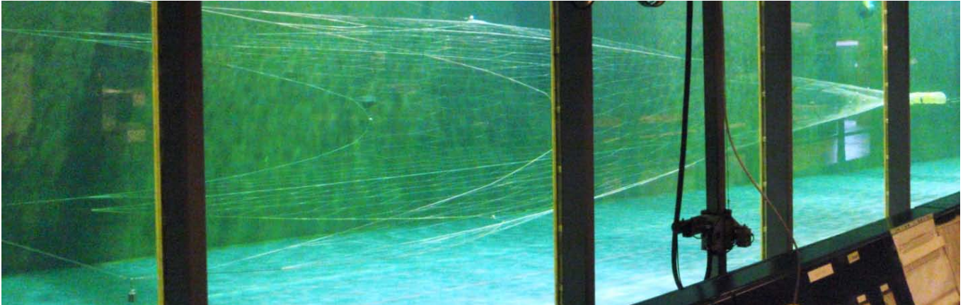
Figur 1: Samlet oversikt over trål modellen i prøvetanken.
