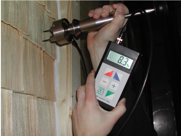
Figur 3.18 Måling av trefuktighet ved mobile elektroder i kløyvd spon
