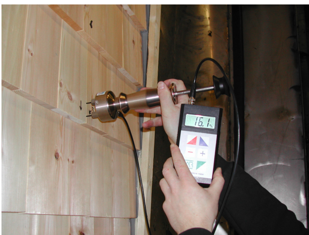
Figur 3.22 Måling av trefuktighet ved mobile elektroder i sagd spon
