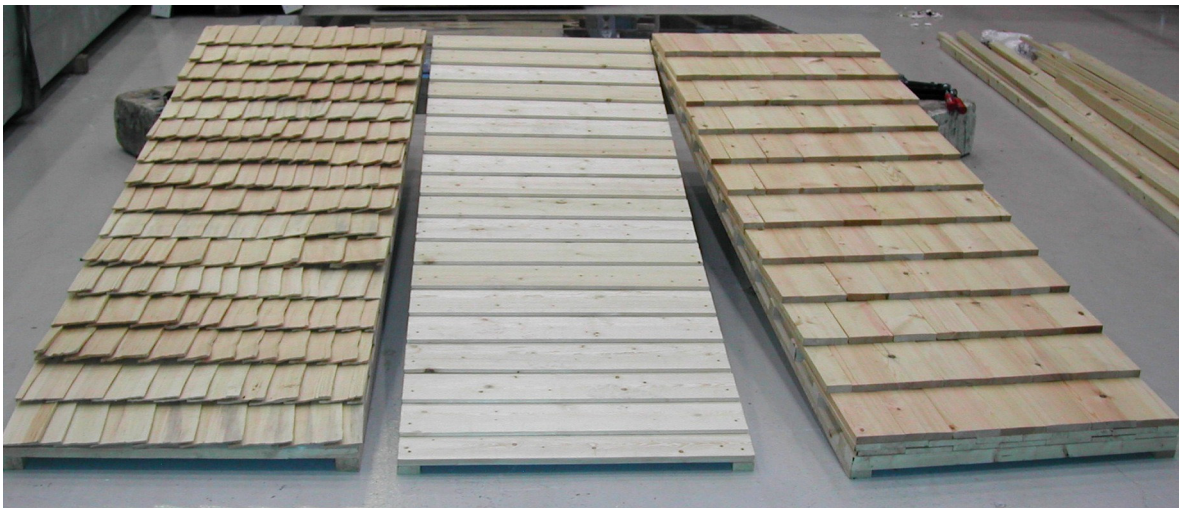
Figur 3.3 Alle de tre kledningsfeltene. Kløyvd spon til venstre, dobbelfalset kledning i midten og sagd spon til høyre.
