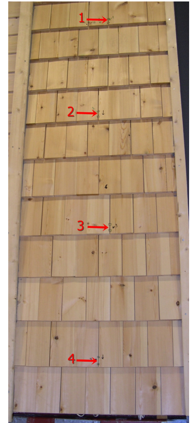
Figur 3.17 Målepunkter for trefuktighet i feltet med sagd spon
