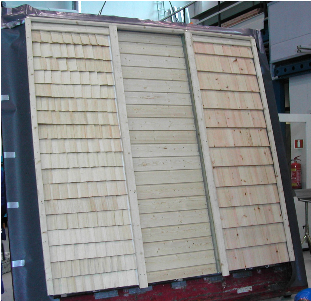
Figur 3.6 Veggfelt montert i ramme og klar til innheising i RAWI-boks
