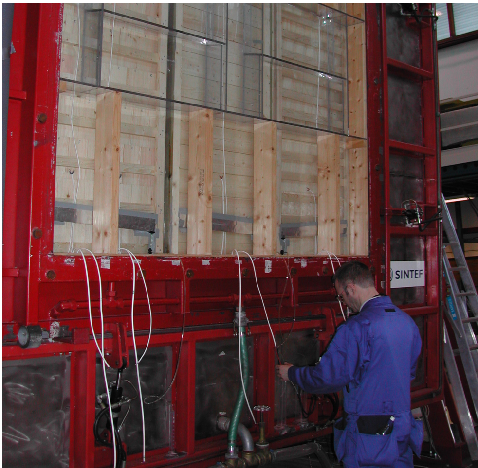
Figur 3.7 Måling av fuktinnhold ved hjelp av fastmonterte elektroder
