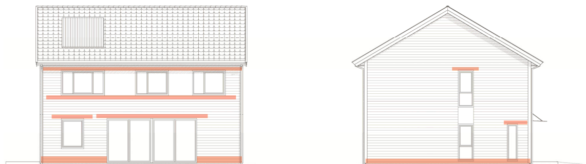
Figur 3.5.1.1. Fasadene på en enebolig fra Nordbohus – røde linjer indikerer utsatte områder
