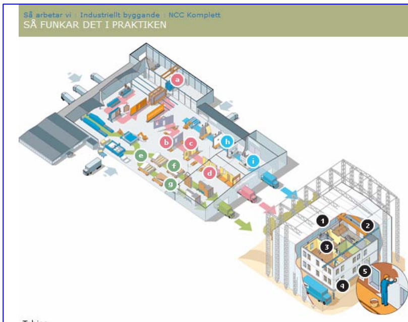
Figur 6.2.1 Prinsippkisse som viser produksjonskonseptet til NCC Komplet
