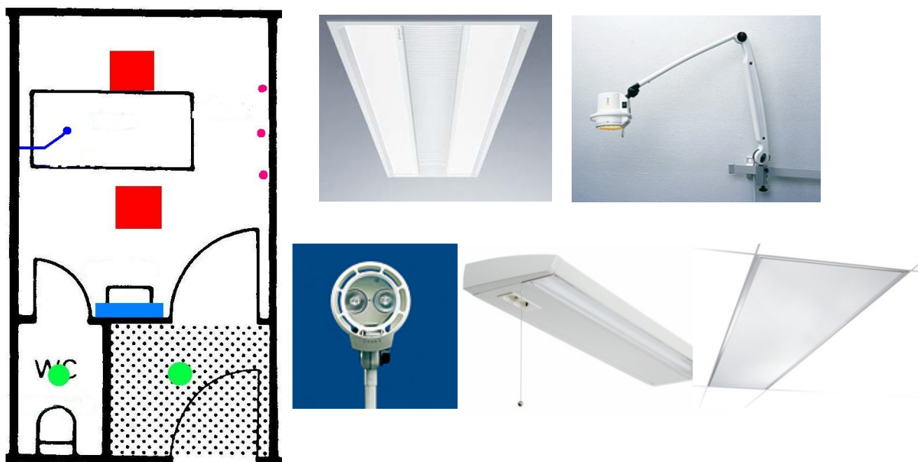
Figur 43 Armatortyper og plassering i baderom
