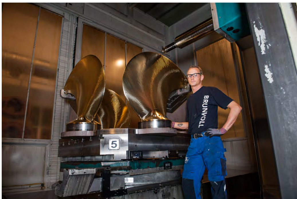
HELT PROPELL: CNC-operatør Edvin Terje Ødegård jobber med maskinering av propellblader. (Foto: Brunvoll)
