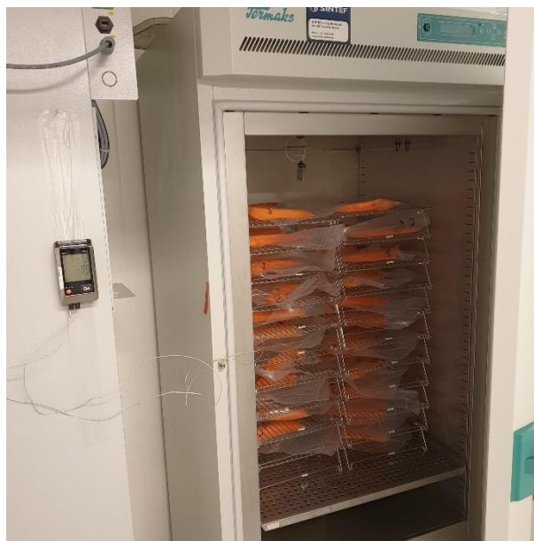
Figur 6: Programmert temperaturforløp under hurtig tining (t.v.). Utførsel av hurtig tining i tineskap; produkter plassert spredt på rister med temperaturlogger til høyre i bildet (t.h.)
