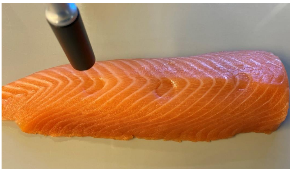
Figur 10: Plassering av nedtrykk ved teksturanalyser
