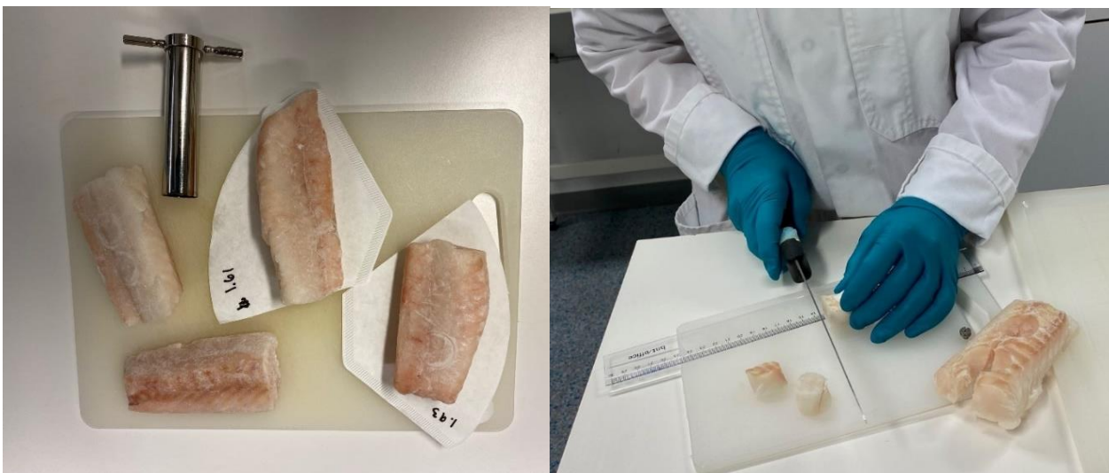
Figur 3: Til venstre vises torskeloins med og uten filterpapir, samt korkbor som benyttes for prøveuttak. Til høyre vises prøvepreparering av torskeloin til 20 mm høyde.
