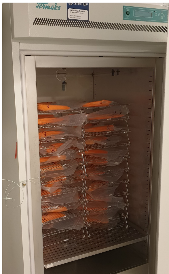
Tining av lakseporsjoner i klimaskap med kontrollert temperaturprogram. Fra forsøk ved SINTEF
