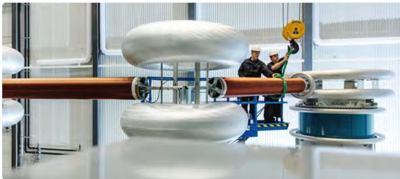
Høyt oppe: Riggning av forsøk i høyspenningshallen på SINTEF Energy Lab.
