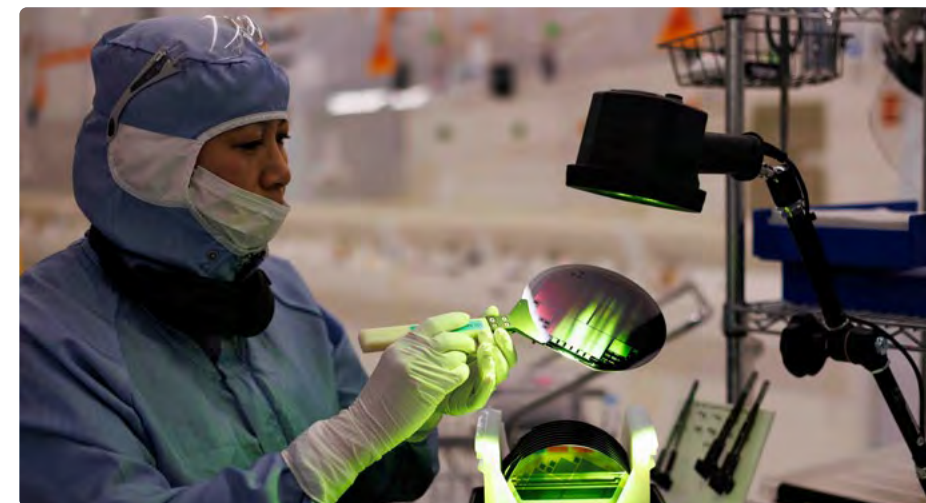
Silisiumskiver under lupen: Senioringeniør Leny Nazareno inspiserer silisiumskiver for partikler og feil i mønster. Det kraftige grønne lyset er monokromatisk (ensfarget), og da vil selv små partikler og feil i mønster bli synlige uten mikroskop.
