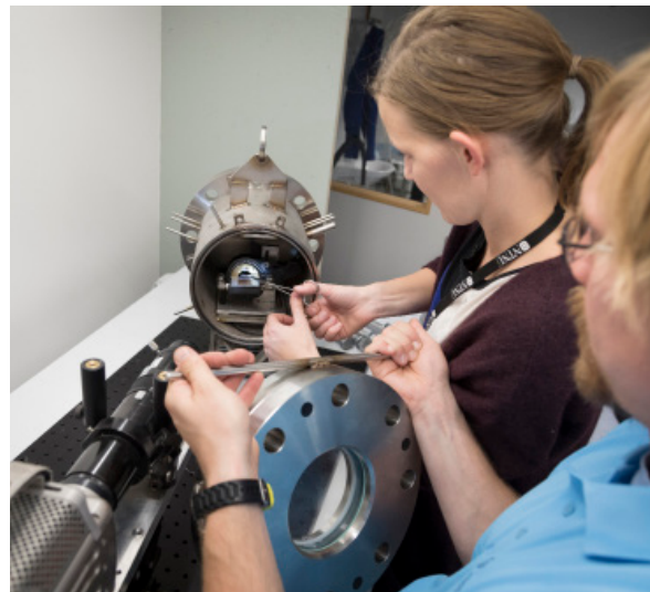
Nanostrukturert overflate plasseres inn i reaktor for å studere CO 2 -kondensasjon ved høyt trykk og lav temperatur.
