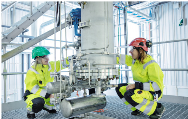
Gassifiseringsreaktoren i forbrenningslaboratoriet i SINTEF Energy Lab.
