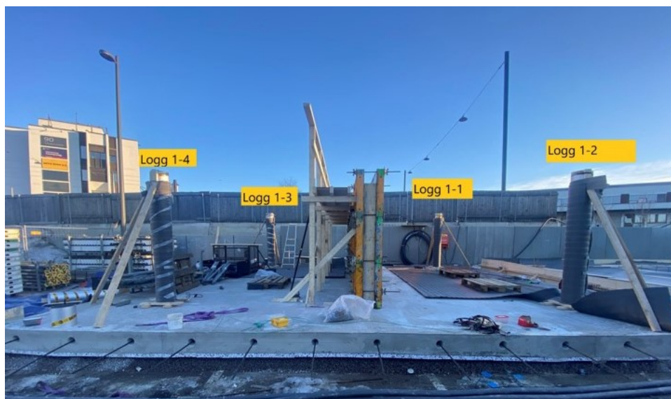
Figur 14-10: Ulike prøvestøper ble logget for å få mer kjennskap til ulike dimensjoner og effekten av flere tiltak. (Foto: Alf Egil Mathisen)
