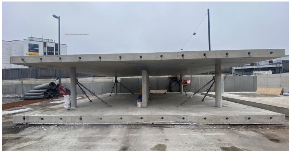
Figur 14-11: Ene delen av fullskala prøvestøp som ga mye verdifull informasjon om bransjens mest miljøvennlige betong og effekten av ulike herdetiltak. Alt av prøvestøp ble revet/fjernet etter alle testene var blitt gjennomført. (Foto: Alf Egil Mathisen)
