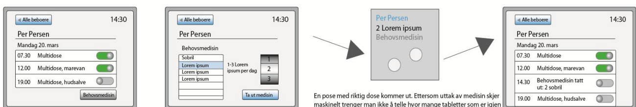
Figur 50 Ansatt velger medisin og mengde, ved bruk av berøringsskjerm. Tidspunkt for uttak og mengde medisin registreres. Riktig medisin kommer ut.
