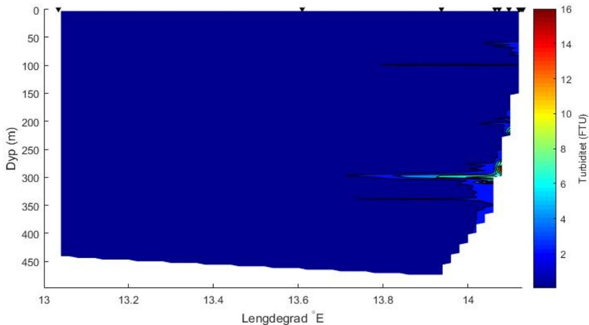
**Figur 17.** Profil av turbiditet (FTU) per dyp (y-akse) i Ranfjorden (x-akse gir lengdegrader ut fjorden) med stasjonene markert med sorte punkter. Konturplottet viser gjennomsnittsverdier per 1 m dyp. I luftlinje tilsvarer transektet horisontalt omtrent 54 km, så høyde-breddeforholdet i figuren er ikke korrekt.
