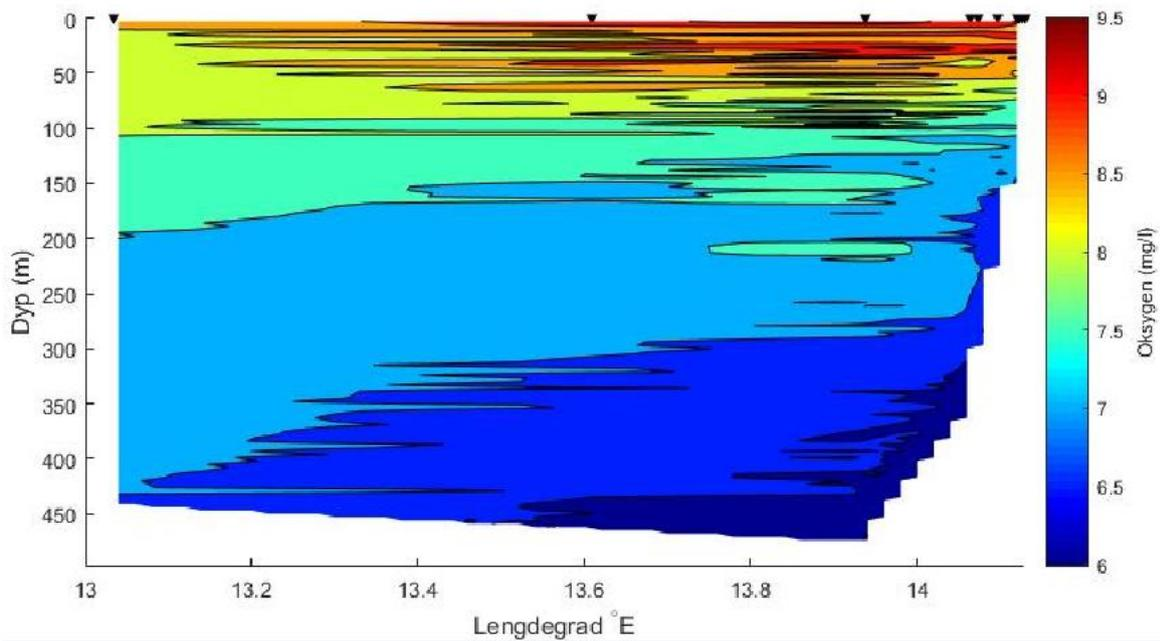
**Figur 18.** Profil av oksygen (mg/l) per dyp (y-akse) i Ranfjorden (x-akse gir lengdegrader ut fjorden) med stasjonene markert med sorte punkter. Konturplottet viser gjennomsnittsverdier per 1 m dyp. I luftlinje tilsvarende transektet horisontalt omtrent 54 km, så høyde-breddeforholdet i figuren er ikke korrekt.
