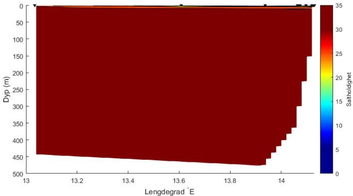
**Figur 15.** Profil av saltholdighet per dyp (y-akse) i Ranfjorden (x-akse gir lengdegrader ut fjorden) med stasjonene markert med sorte punkter. Konturplottet viser gjennomsnittsverdier per 1 m dyp. I luftlinje tilsvarer transektet horisontalt omtrent 54 km, så høyde-breddeforholdet i figuren er ikke korrekt.
