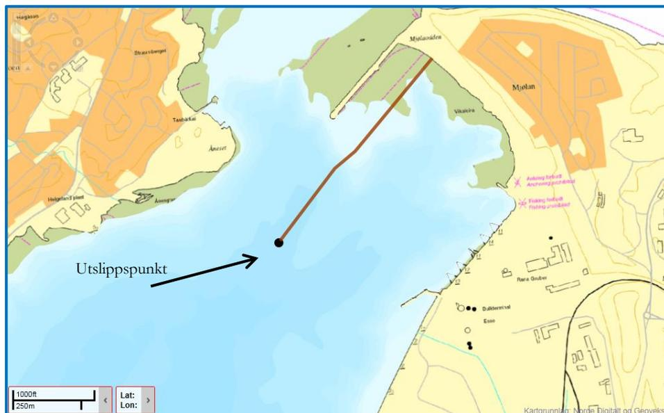
**Figur 6.** Kart med nytt felles utslippspunkt for grov- og finfraksjon for avgang fra Rana Gruber. Utslipppet er på 127 meters dyp.
