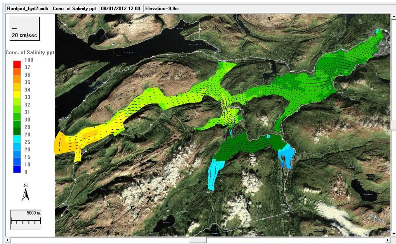
**Figur 9.** Kart over strømforhold i Ranfjorden. Under overflaten er strømmene sterkt påvirket av tidevannet. Her er et eksempel på strøm 1. august 2012 på 10 m dyp. Ferskvannpåvirkningen er betydelig mindre enn i overflaten.
