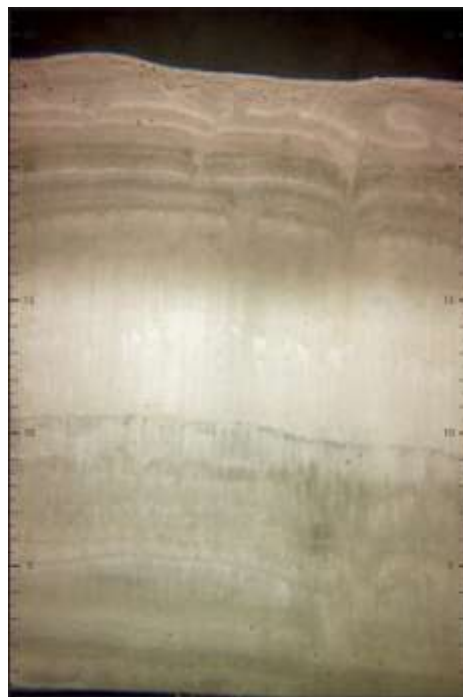
Bildet viser bunnprofilen av et deponi i Frænfjorden (et kamera som er senket ned i selve deponiet). DNV, 2010.
