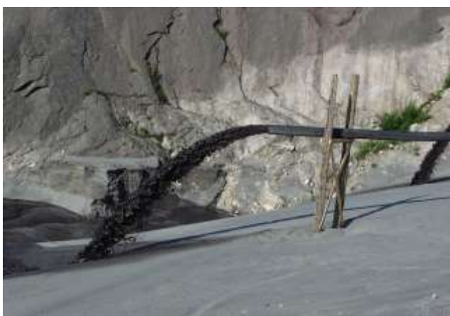
Bildet ovenfor viser deponering av avgang fra ilmenitt- produksjonen på Titania via rør til landdeponiet. Foto: Ann-Heidi Nilsen, Titania as.
