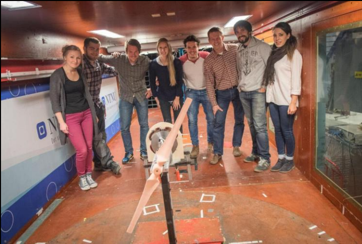
NTNU Vindtunnel: Enkeltturbiner 2.7 m x 1.8 m seksjonsareal Vmax: 22 m/s
