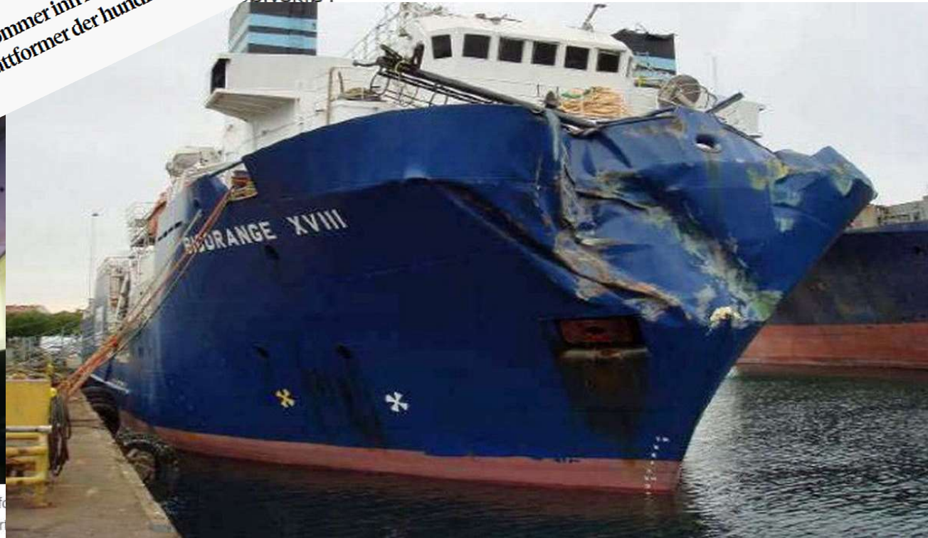
STØYTTE SAMAN: Eit supplyskip støytt saman med Statfjord A-plattformen. Biletet syner at skipet treffe ved redningsflåtane, rett under bustadkvarteret. FOTO: STRIL HERCULES/SCANPIX
