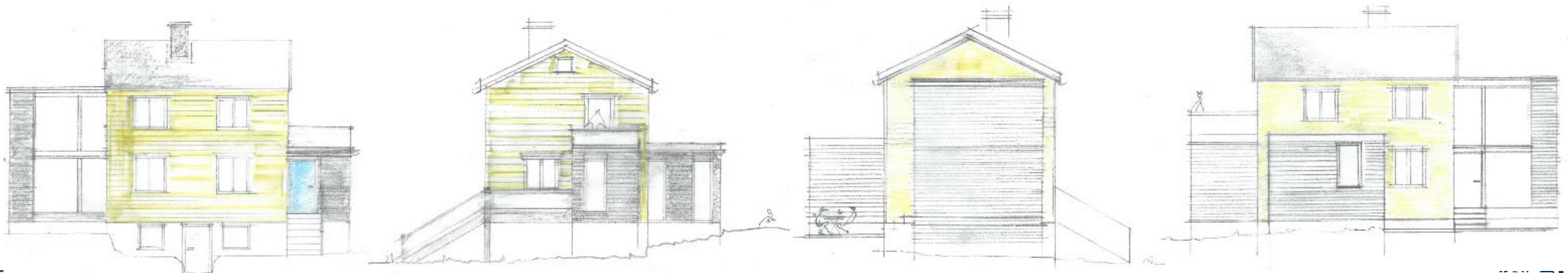
Fasader med tilbygg mot SV i to etasjer. Nytt soverom over stue. Urainær takhøyde (2.40m) i begge etasjer.
