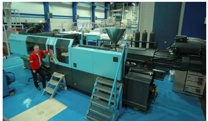
Borealis' nye hybridmaskin fra Demag (350/810-3300 EL-EXIS S). Denne 350-tonneren er en racer på tynnvegget emballasje. Se også tekst og figur på neste side.
