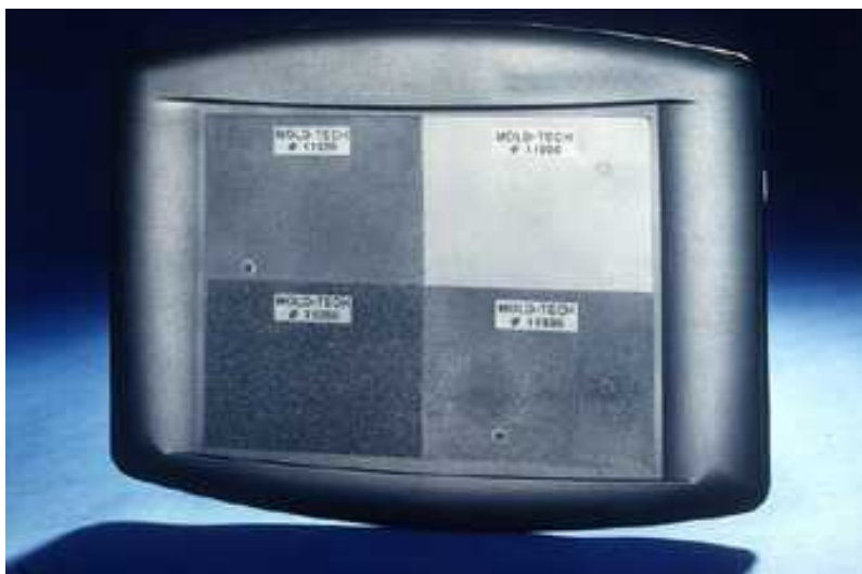
Skjerm til bærbar datamaskin produsert med sekvensiell fylling (© 1997 GE Plastics)
