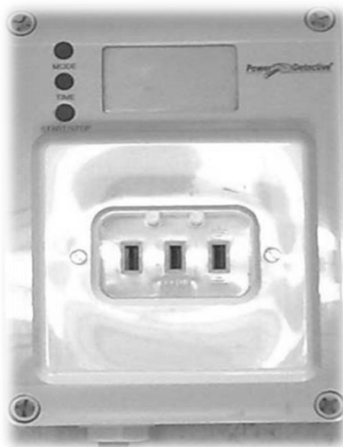
Figur 3-2 Power Detective måleadapter for komfyr[13]
