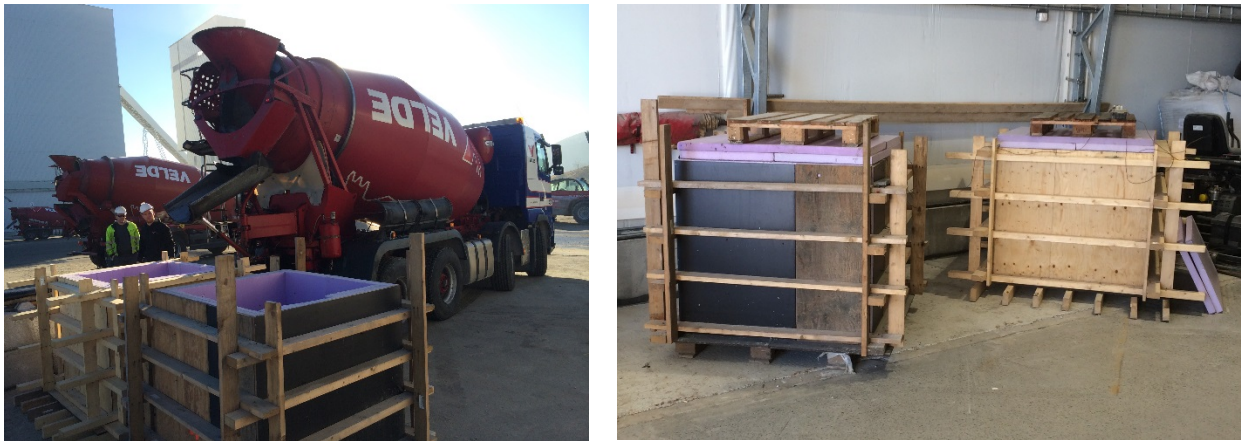
Figur 6 Herdekasseforsøk – Isolerte 1 m3 kasser før støp og under måling
