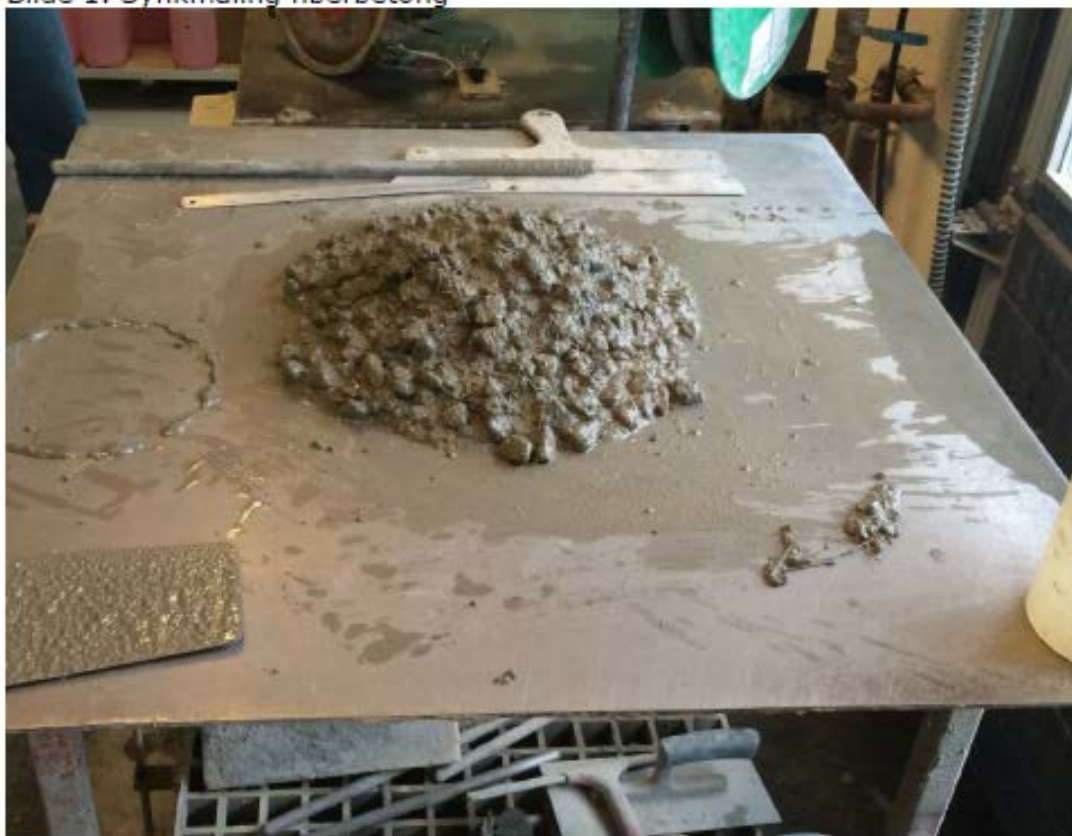
Bilde 1. Synkmåling fiberbetong
