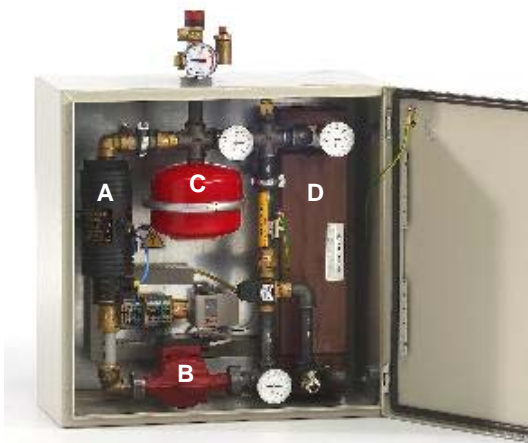
Figur 3.14 Eksempel på elektrodekjelsystem for oppvarming av boliger med vannbårent varmesystem.
