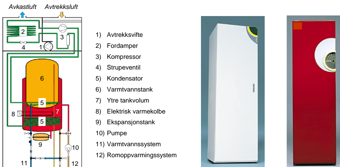
Figur 3.48 Prinsipiell skisse av en avtrekksluft-varmepumpe for kombinert varmtvannsberedning og romoppvarming samt eksempler på kommersielle aggregater (Fehrm, 2005).
