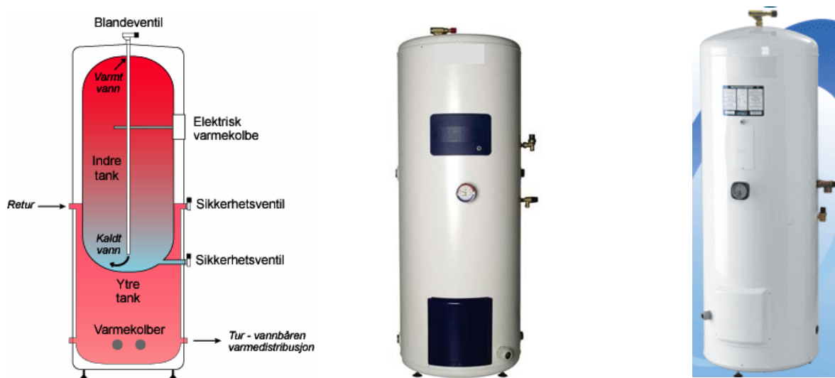
Figur 3.12 Prinsipiell skisse av dobbeltmantlet varmtvannsbereder med elektriske varmekolber i indre/ytre tank samt eksempler på kommersielle beredere.
