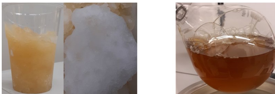
Figur 3: Eksempel av Fryse-konsentrert (12 %) hydrolysat og separert is (venstre), og vakuumpkonsentrert (25%) hydrolysat (høyre)
