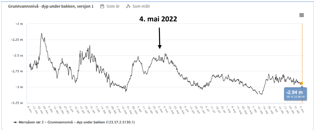
Figur 4-16. Grunnvannstand (meter under terreng) for 8. november 2021 til 7. november 2022 for grunnvannstasjon Merraåsen 2 5 . Grunnvannstand 4. mai er markert med svart pil.
