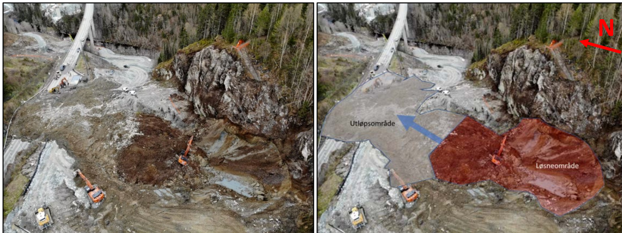
Figur 3-4. Venstre: Dronebilde av skredet (Stjørdalsnytt 6.5 2022, foto v/Karl-Marius Sneisen). Høyre side: inntegnet areal for løsne- og utløpsområde ved skredet 4. mai (SINTEF AS). Blå pil angir utløpsretning.
