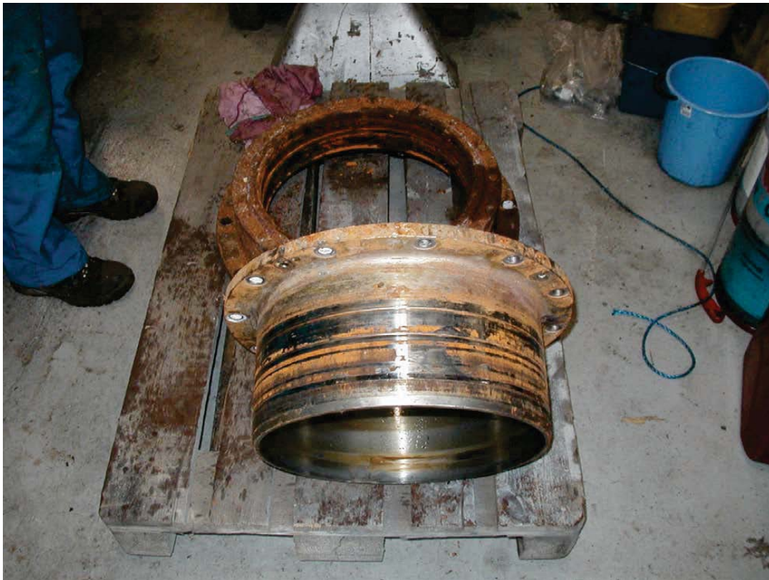
Figur 20. Eksempel på korrodert hylsetetningsboks og slitt liner
