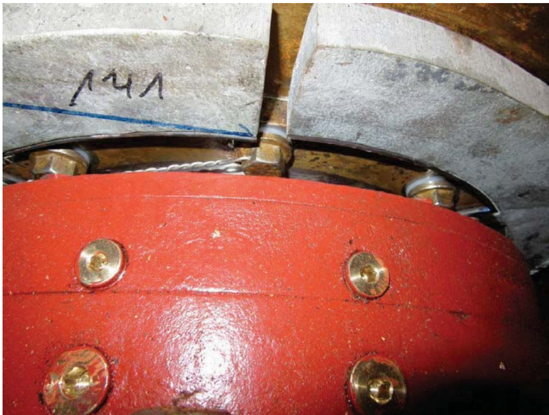
Figur 22. Reparert hylsetetning med sinkanoder
