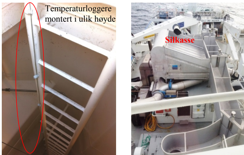
Figur 4. Bilder som viser hvordan temperaturloggerne ble montert i RSW-tank om bord på M/S Ligrunn (venstre) og oversikt over silkassen og renne til RSW-tanker om bord på M/S Liafford (høyre). Foto: SINTEF Fiskeri og havbruk.
