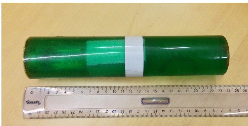
Figur 11. Sensorfisk med refleksbånd.
