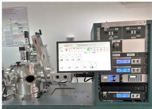
Stand pentru determinarea inovativa a rezistentei de contact interfacial (ICR), realizata in cadrul proiectului
