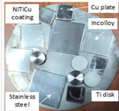
Filme depuse prin pulverizare magnetron pe diferite substraturi (stanga) si evidentiarea grosimii filmelor depuse (dreapta)
