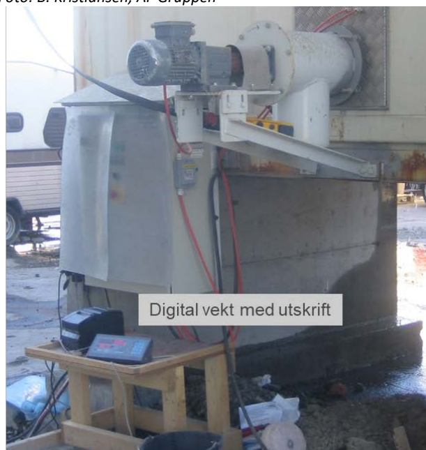
Figur 18. Tobb med veiecelle (venstre) og digital vekt med utskrift (høyre).
