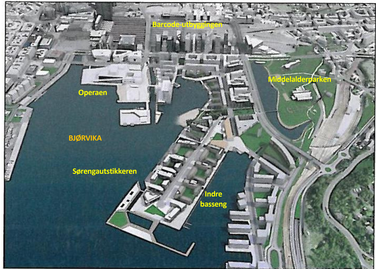
Sjørengautstikkeren, oversikt - Utbyggingen foregår på en utstikker i Bjørvika-området, med fundamentering på peler til fjell. I bakkant Barcode-utbyggingen, Operaen skrått opp t.v., Middelalderparken skrått opp t.h..
