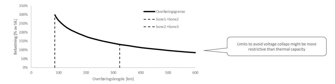
St.Clairs kurve: Overføringsgrense som funksjon av overføringslengde. SIL ≈600MW ved 420 kV og ≈300MW ved 300 kV
