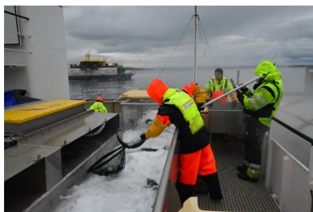
Figur 20 – Utløpssiden på Hydrolicer LH2245 Hydroflow. Fisken telles etter pumping (doble ejetorpumper) med Vaki fisketellere (gule lokk) før avluset laks kommer ut i rennen fylt med vann for overføring til merd. Posisjon 2: Fisk for lustelling, evaluering av stress og velferdsscore ble håvet ut på utløpssiden og overført til kar plassert ved rennen (høyre bilde).
