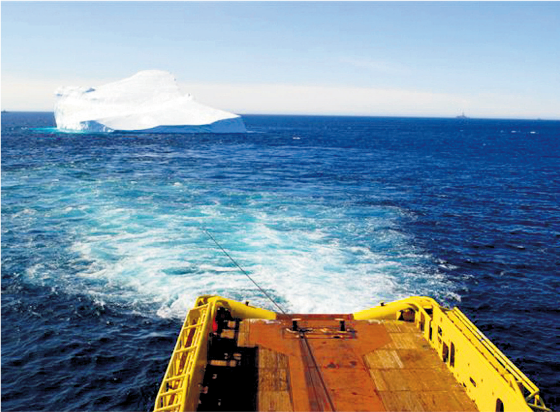
Flytter fjell: Over 400 isfjell er flyttet i år. På bildet sleper Trans Viking et isfjell på 2,9 millioner tonn. Kristiansand-selskapet MD Group AS har utviklet utstyret som håndterer isfjellproblemene. I bakgrunnen Cairns leteplattform. Foto: Trans Viking, Viking Supply Ships
