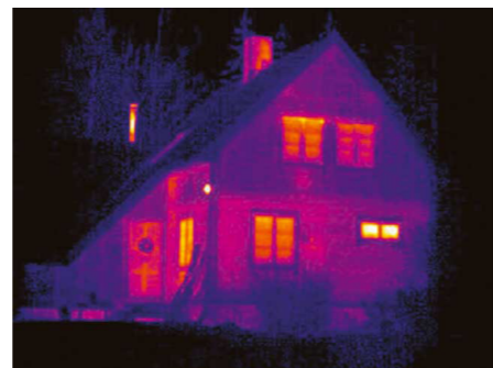
Fig. 1. Termogram av en eldre enebolig. Hvit farge indikerer høyest utstråling og rød-gule farger betyr høyere utstråling enn svarte og blå (kalde) farger.
