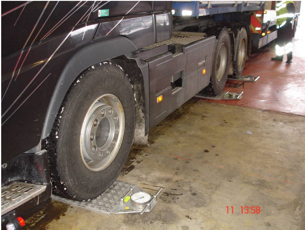
Figur 2.12: Oppsett for veiing med mobile vekter
