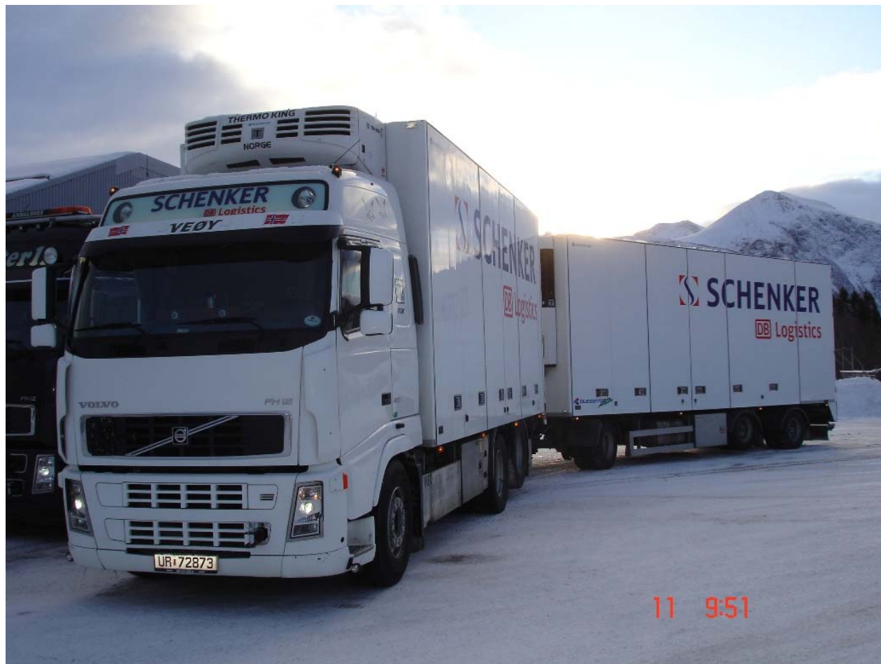
Figur 2.5 Bil A: lastebil med boggi og henger, Volvo FH12 med motoreffekt 338 kW (460 HK)
