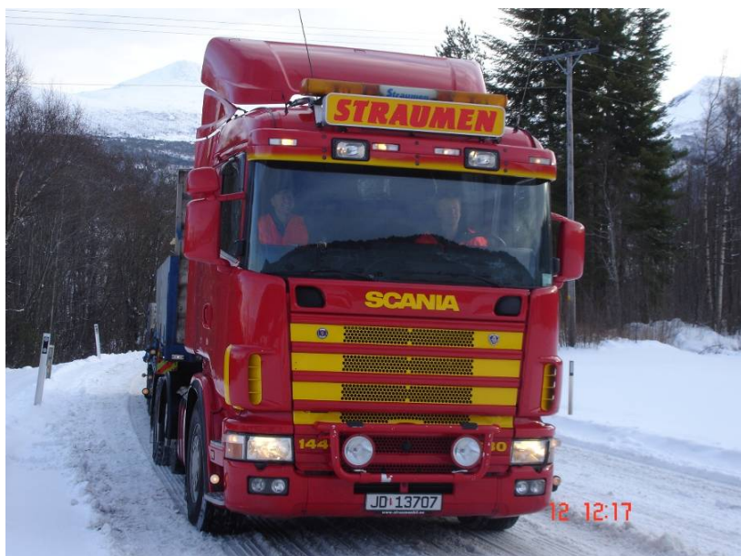
Figur 3.35 Kjøretøy D kl 12:17, må heve boggien for å ta løs i stigningen
