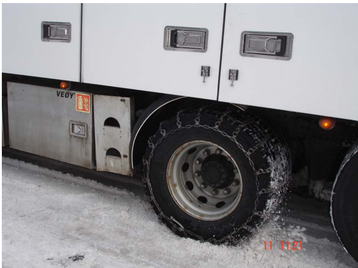
Figur 3.12 Kjøretøy A, forsøk på å ta løs med kjetting på venstre drivhjul
