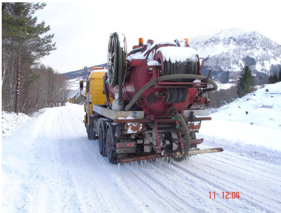
Figur 3.18 Det ble foretatt preparering av føreforholdene med vanning ca kl 12:00
