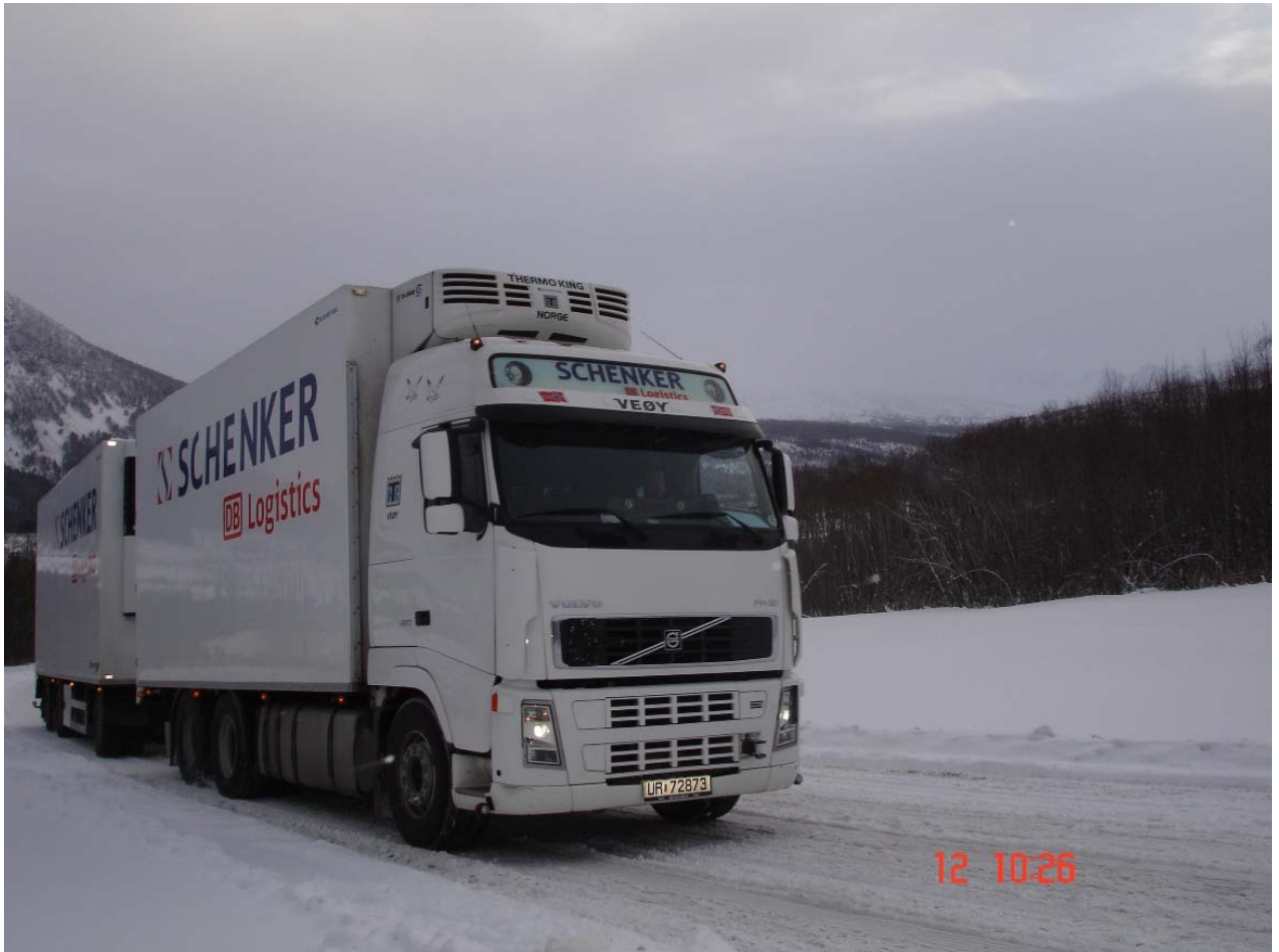
Figur 3.31 Kjøretøy A kl 10:26. Boggi nede med redusert boggitrykk. Ingen stans i stigningen
