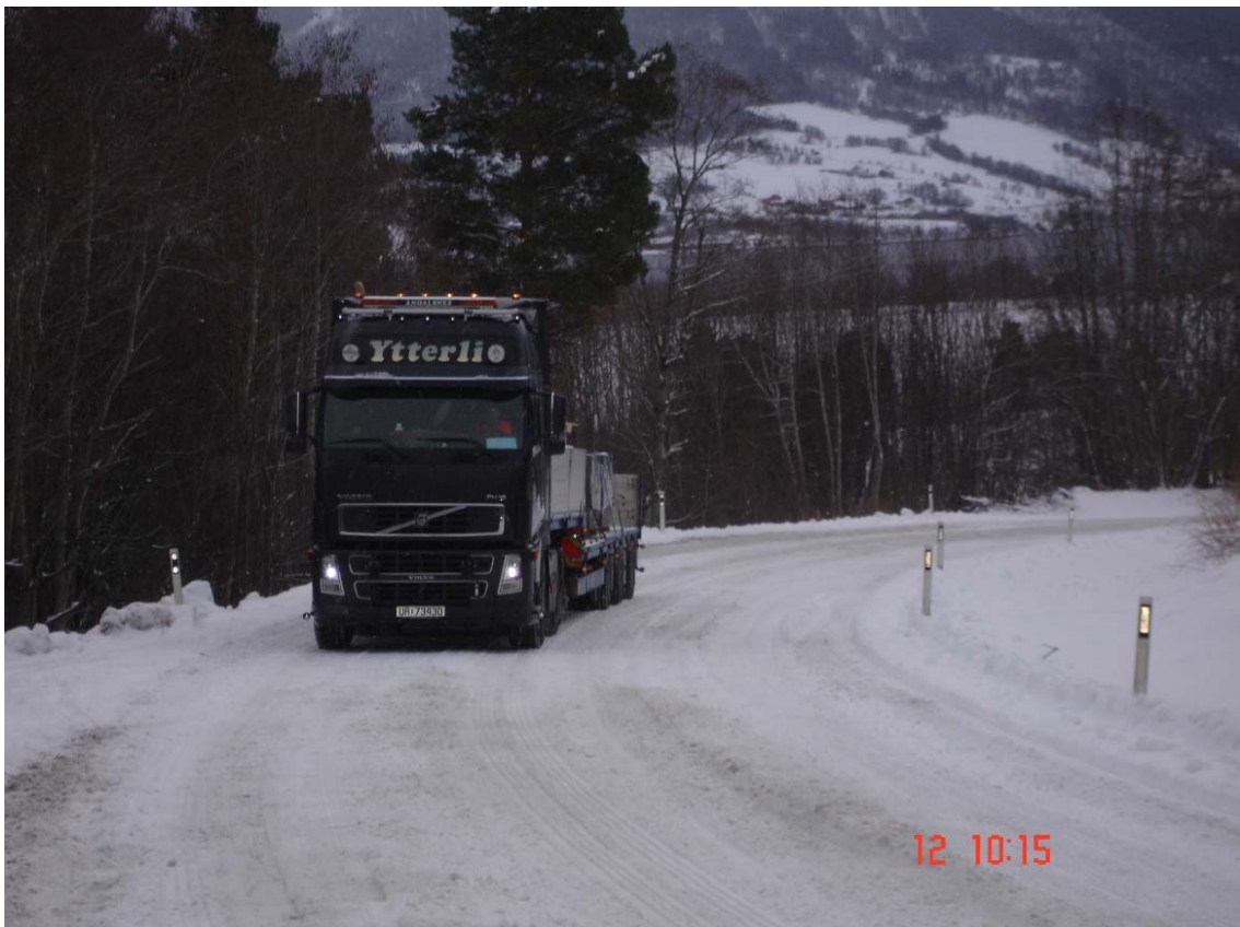
Figur 3.29 Kjøretøy B kl 10:15. Full stans ved profil 200. Tok løs etter heving av boggi
