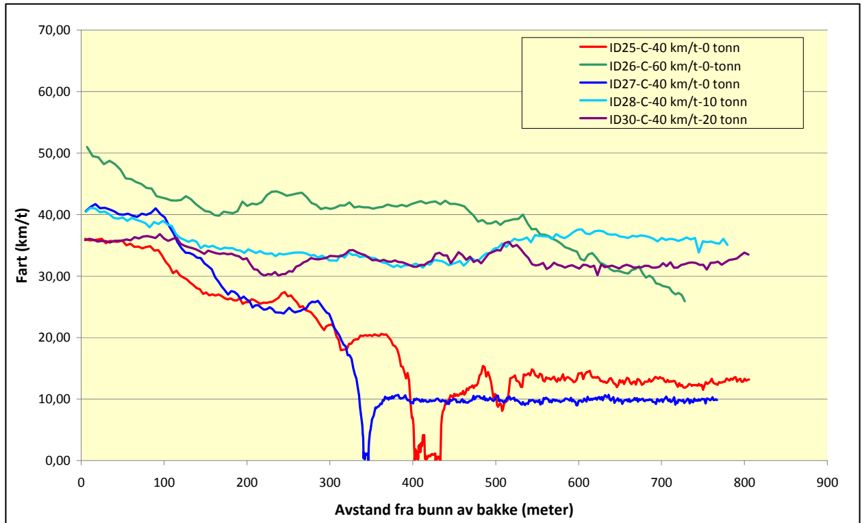
Figur 3.45: Bil C, semi-trailer uten boggi med varierende last
