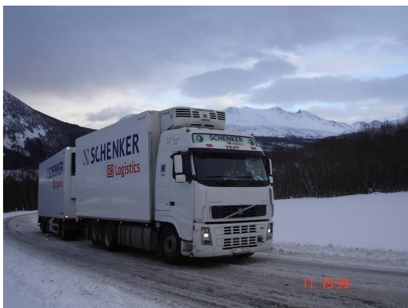
Figur 3.24 Kjøretøy A, utgangsfart 40 km/t og 10 tonn last, kl 15:39. Kjøretøyet må ha boggien oppe for å komme opp stigningen
