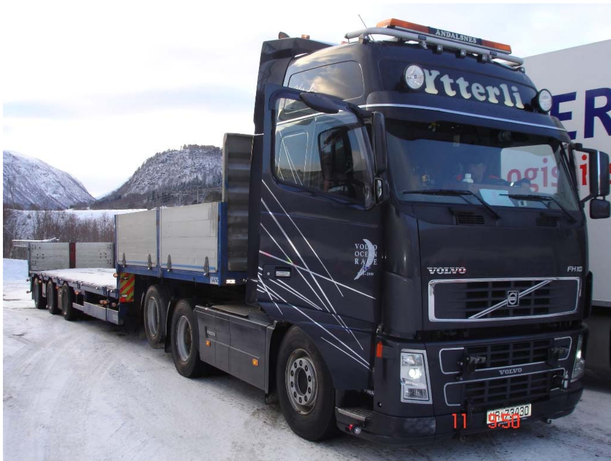
Figur 2.6 Bil B: Semi-trailer med boggi, Volvo FH16 med motoreffekt 404 kW (550 HK)
