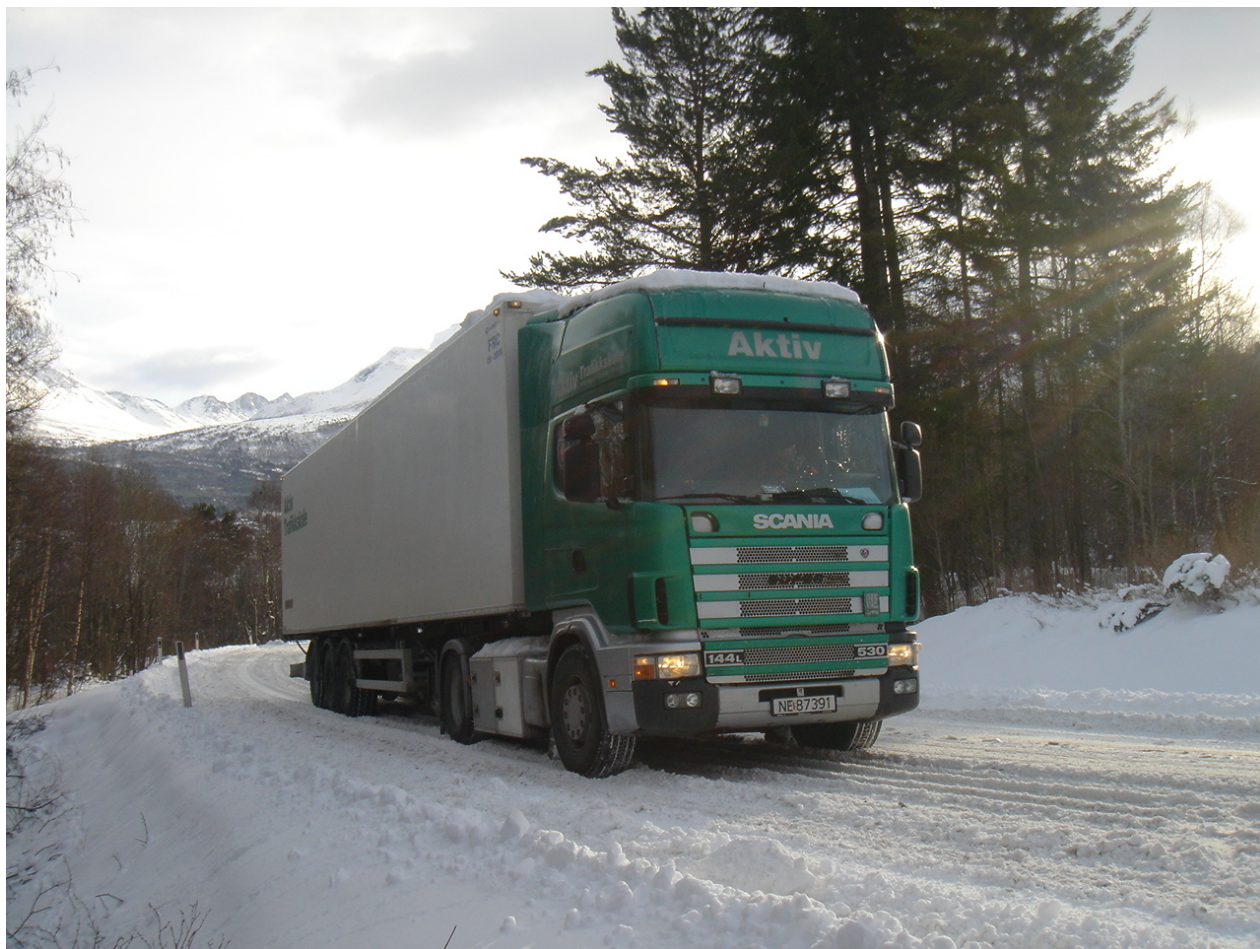
Figur 2.7 Bil C: Semi-trailer uten boggi, Scania 530 med motoreffekt 390 kW (530 HK)
