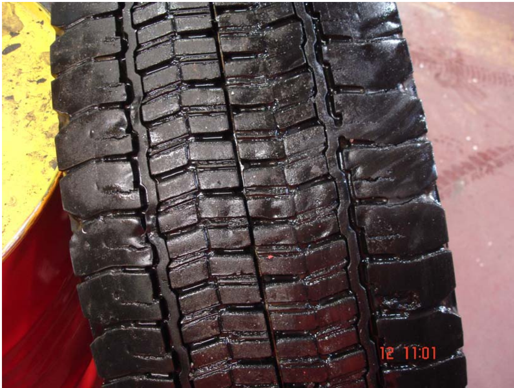
Figur 2.9: Norsk vinterdekk. Shoreverdi: 64
