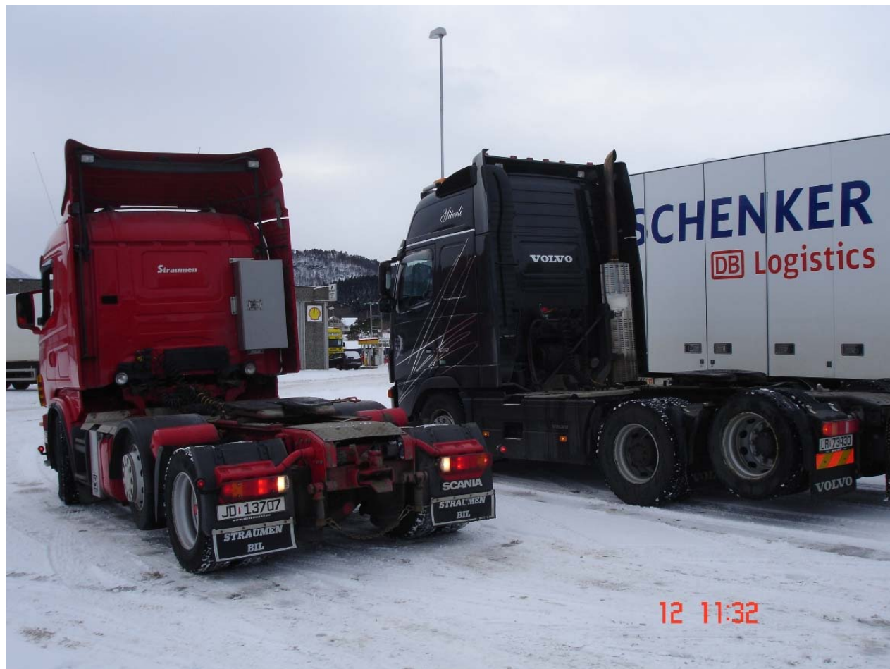
Figur 2.8 Bil D: Pusher-bil, Scania G380 med motoreffekt 295 kW (400 HK)
