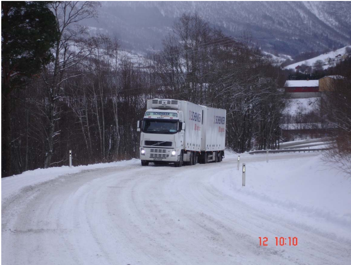
Figur 3.28 Kjøretøy A kl 10:10. Full stans ved profil 220. Tok løs etter heving av boggi
