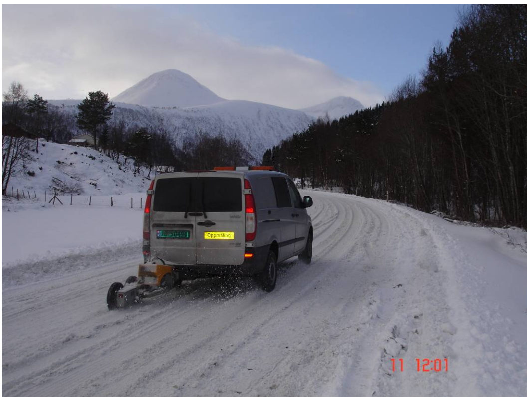
Figur 2.13: Friksjonsmåling med måler av typen TWO
