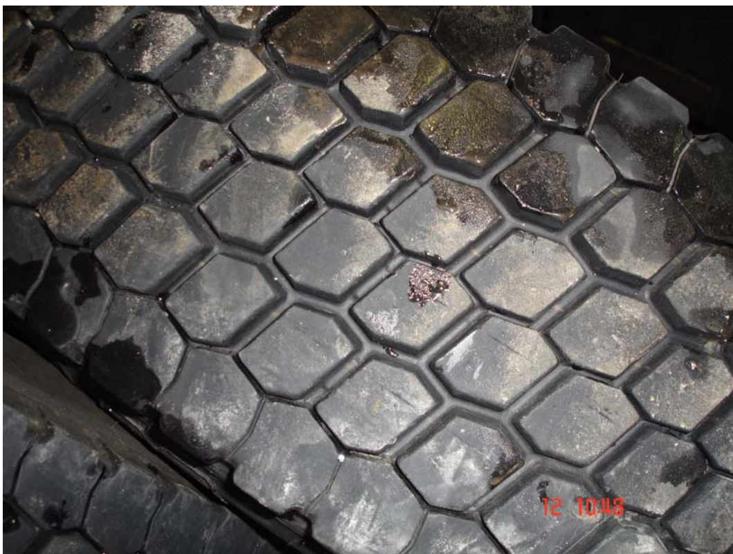
Figur 2.10: "Utenlandsk" knastedekk. Shoreverdi: 72
