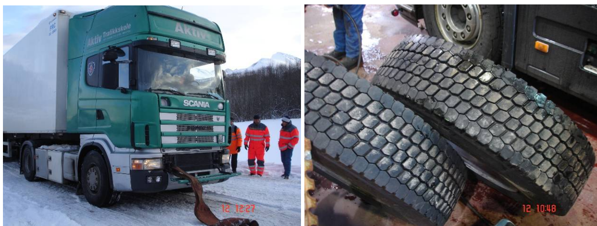
Figur 3.34 Kjøretøy C, kl 12:27. Greier ikke ta løs i stigningen med harde dekk
