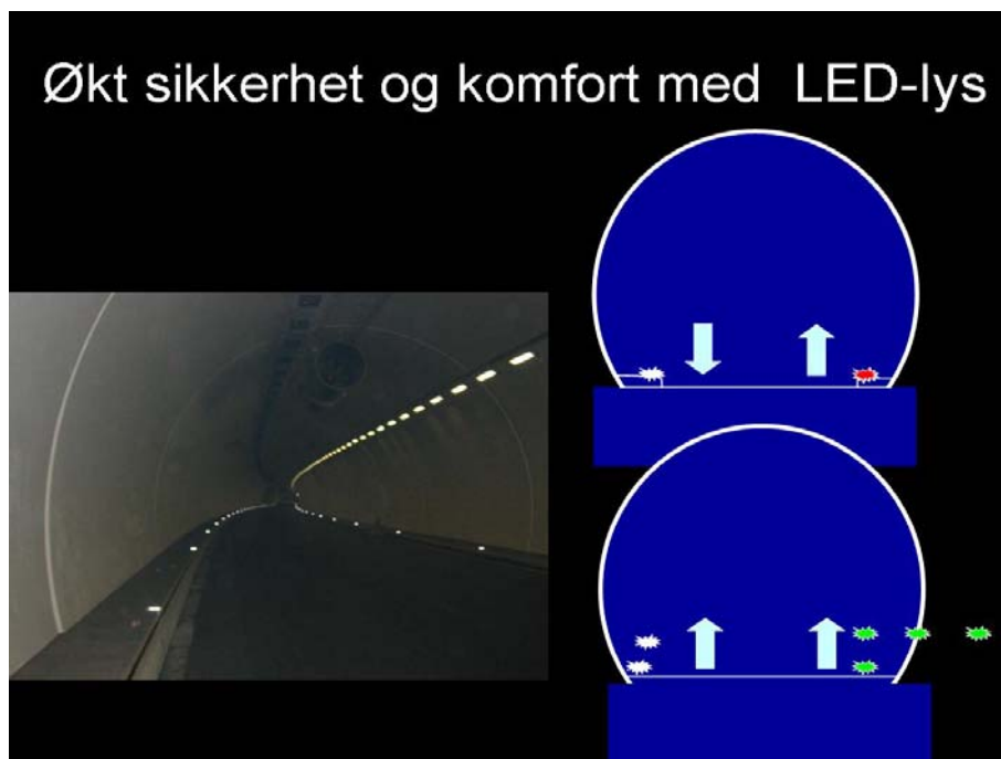
Figur 3-5: Kantbelysning (LED-lys) for økt komfort og sikkerhet (kilde SINTEF)
