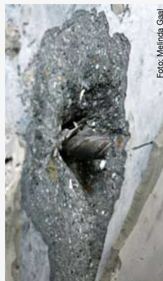
Slik ser bolten ut når den er slitt tvert av.
