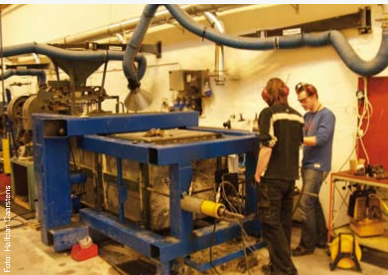
Senioringeniør Trond Larsen hos SINTEF Berg og geoteknikk opererer bolteriggen sammen med Leif Erik Svanø. På slutten av fjoråret hadde de utført 30 bolteforsøk for LKAB.
