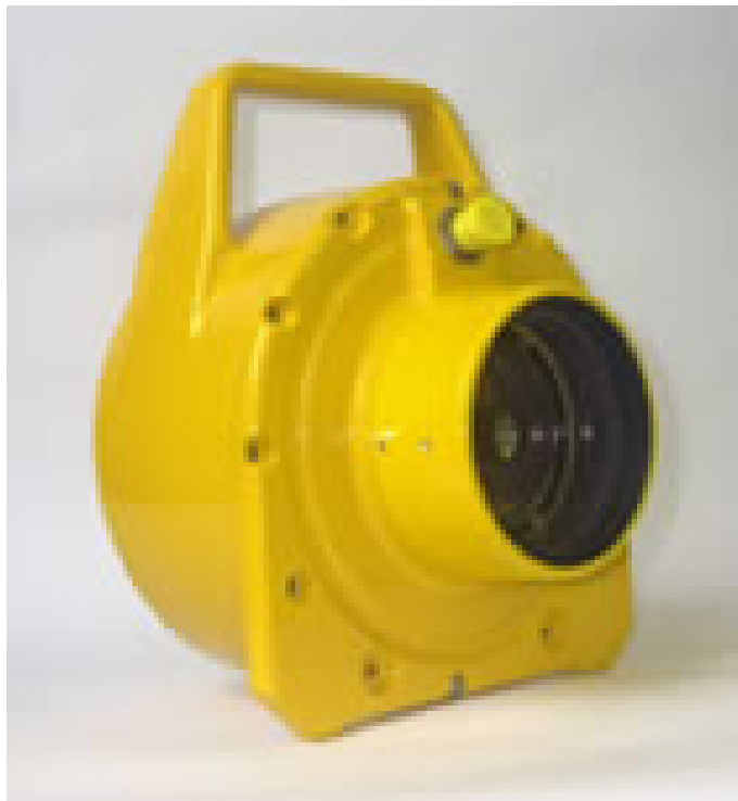
Figur 6 Infrarød tidevann- og bølgehøyde måler ( http://www.blacknor.com/tidewavesensor.html )
