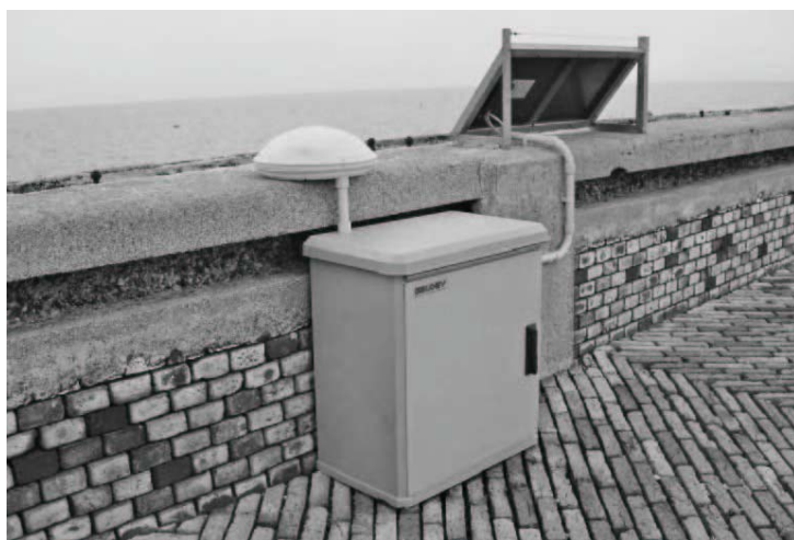
Figur 7 Fullt utstyrt GPS målestasjon [17]
