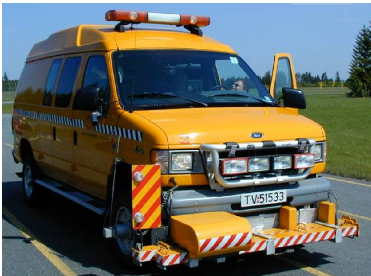
Figur 3 Alfred måleutstyr basert på ultralydsensorer for spormåling og lasermåler for langsgående jevnhet. (Utstyret er nå i ferd med å bli erstattet av et nytt system)
