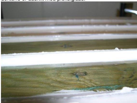
Figur 8 Vannfilm på ca. 3 mm på overflaten av lektene.
