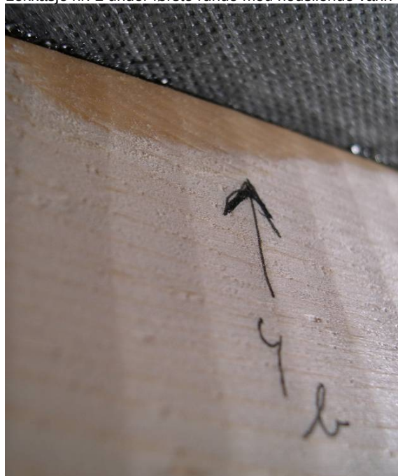
Figur 29 Lekkasje nr. 4 under første runde med nedsilende vann
