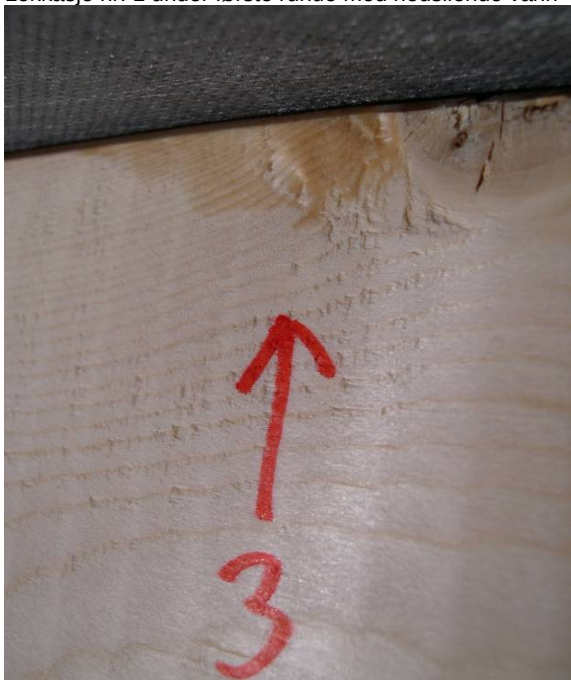
Figur 28 Lekkasje nr. 3 under første runde med nedsilende vann
