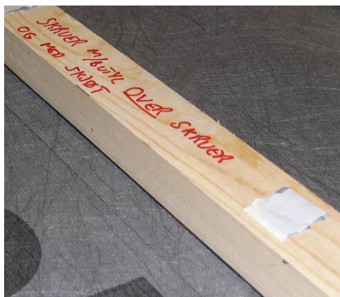
Figur 24 Sløyfe med butyl lapper over skruerhoder
