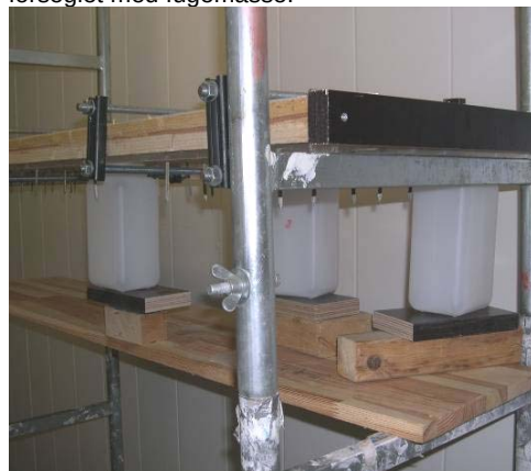
Figur 9 Oppsamling av vann i bokser under prøvene
