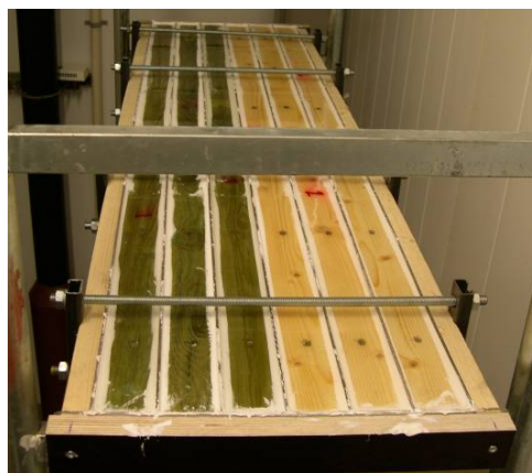
Figur 7 Fugene mellom lektene og pleksiglasset er forseglet med fugemasse.
