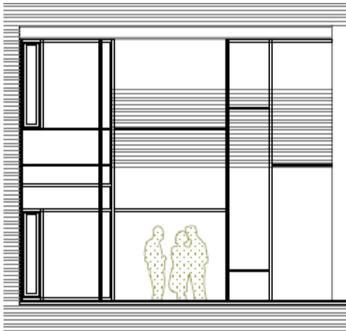
Figur D-14. Vindusmodul, trappehus
