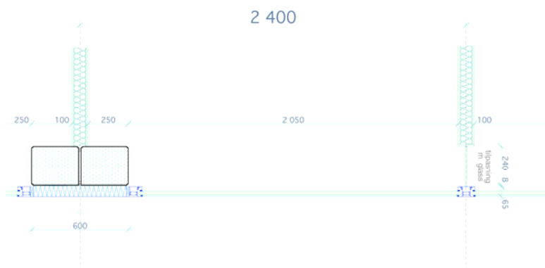
Figur A-5. Horisontalsnitt gjennom vindu.
