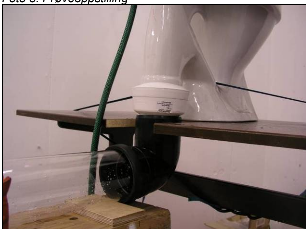
Foto 5: 1 x 88,5° med avstand 150 mm golvnivå/underkant avløpsrør
