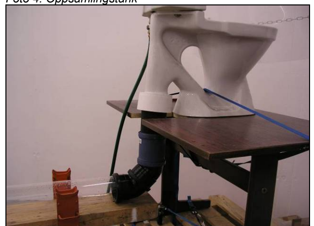
Foto 6: 2 x 45° med avstand 350 mm golvnivå/underkant avløpsrør
