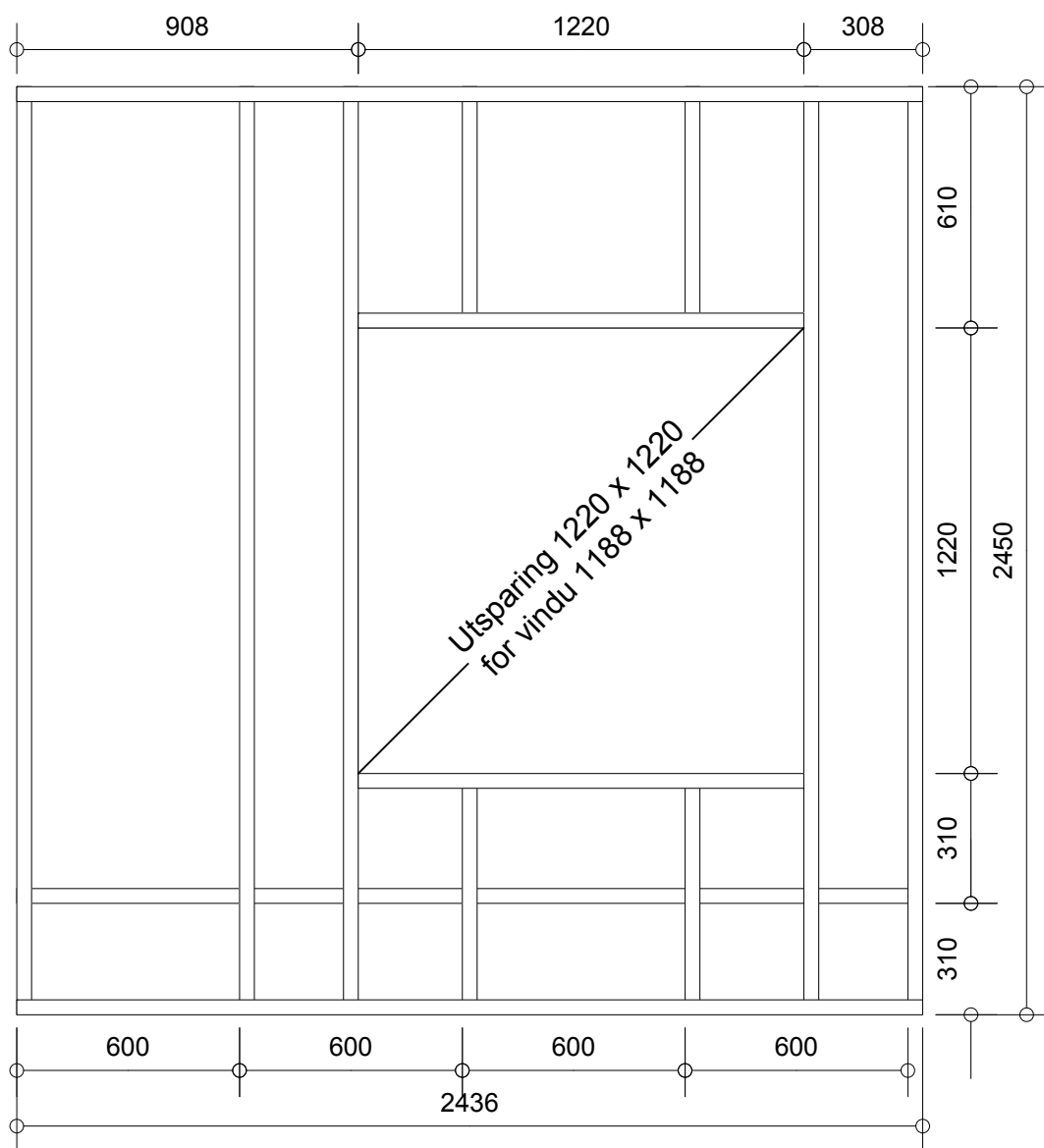
Figur 3.1 Detaljerte mål (mm) for bindingsverket i prøvefeltet
