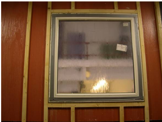
Figur 3.8.1. Prøvefeltet under slagregnsprøvingen
