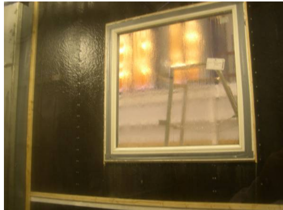
Figur 3.5.2. Prøvefelt under slagregnsprøvingen. Ingen vertikale lekter
