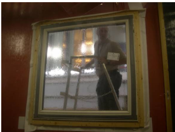
Figur 3.7.3. Prøvefeltet under slagregnsprøvingen
