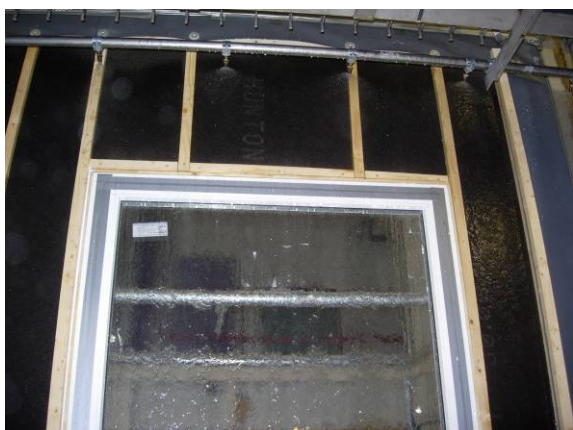
Figur 3.3.3. Prøvefeltet under slagregnsprøvingen
