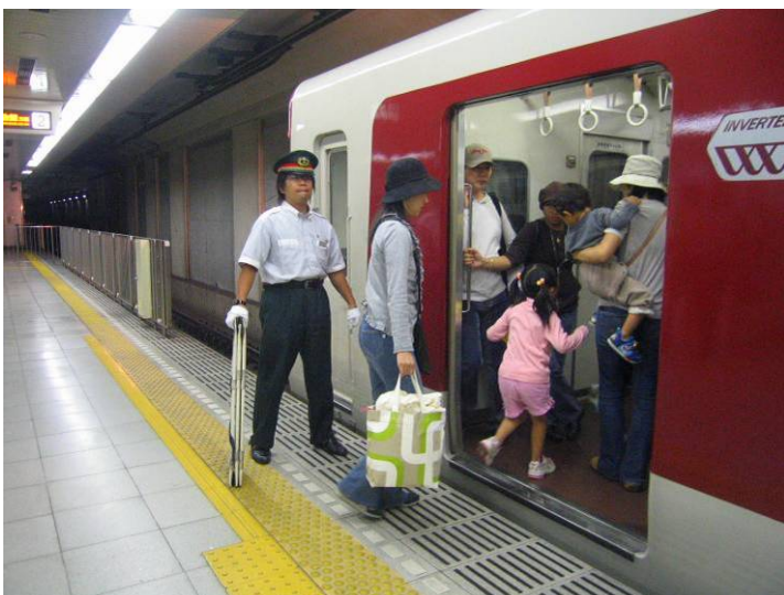
Fig. 75. Kyoto undergrunnsbane. Ledelinjen går langs kanten av plattformen. En lignende løsning på Duivendrecht stasjon i Holland har blitt kritisert både som utrygg fordi avstanden til kanten er for liten og som forvirrende fordi den kan forveksles med faresonen. Det er viktig at ledelinjesystemet gir entydige signaler.
