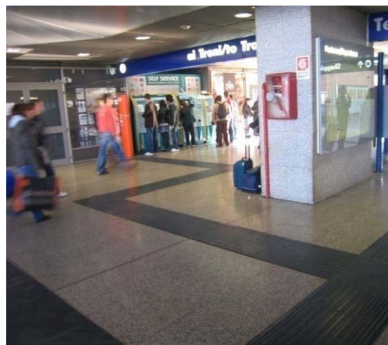
Fig. 38. Et eksempel på unødvendig komplisert ledelinje til automat. Plassering av automater bør vurderes i forbindelse med utførelse av ledelinjene.
