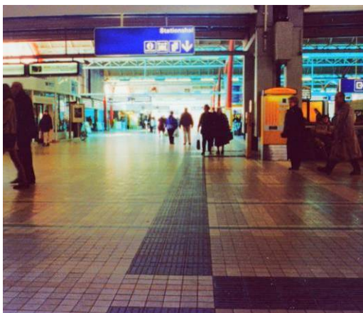
Fig. 66. Utrecht sentralstasjon. Bentheim Crouwel Architects. Det er brukt brede fliser i kontrastfarge og opphøyd relieff. Merk at et særskilt oppmerksomhetsfelt ikke finnes; etter brukermedvirkning fant man at opphør av ledelinje fungerte like godt som et vanlig oppmerksomhetsfelt med runde knaster. Synshemmede som bruker stasjonen kan også få hodetelefoner og en radiomottager med et program som gir hørbar informasjon for å finne fram.
