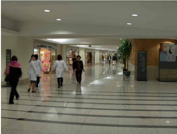
Fig. 16. Ledelinjer i form av kontrastfargede striper kan gå langs eller på tvers av ferdselsretningen. Fra Severance Hospital, Seoul. Arkitekt: Ellerbe Becket, JungLim Architects og Kesson International.
