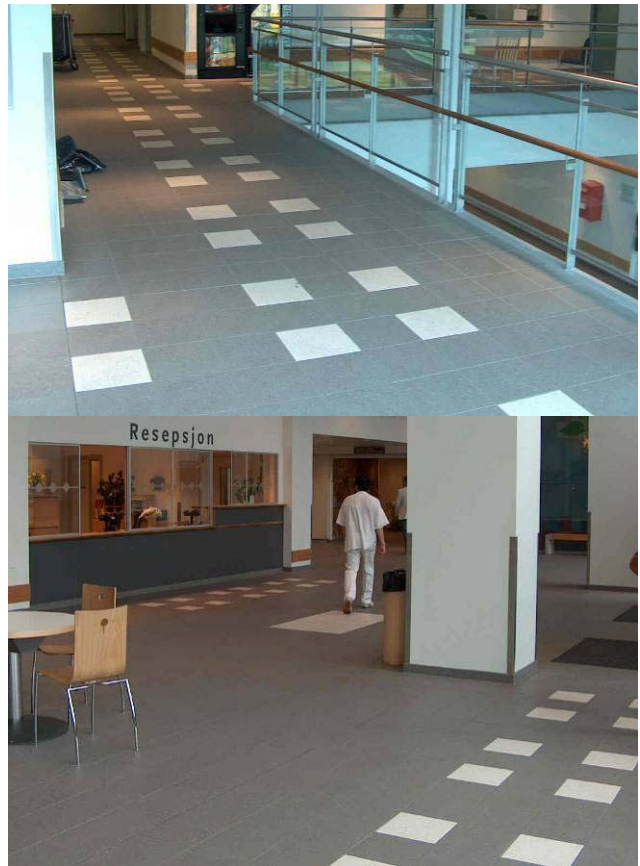
Fig. 24. Bærum sykehus, tilbygg ferdigstilt 2007. Selberg Arkitektkontor AS. Ledelinjer med kontrastfarger er gjennomført i hele tilbygget. Tydelige kontrastmarkeringer og enkelte, men ikke helt systematiske skiller mellom oppmerksomhetsfelt og ganglinjer, for eksempel foran informasjonsskranken på bildet nederst til høyre.
