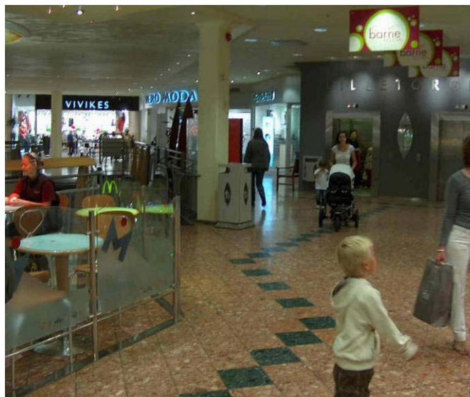
Fig. 52: Ledelinjer må – selv om de ikke er bevisst planlagt som orienteringshjelpemiddel for synshemmede – løpe uhindret for å unngå farer.
