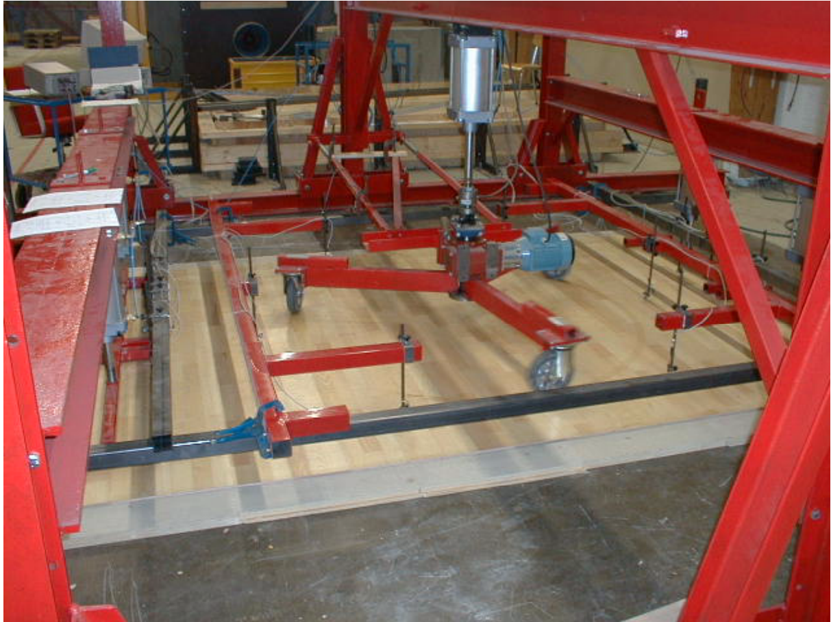
Fig. 14.1. Prøverigg for statisk og dynamisk prøving av lette flytende gulv. (NT Build 384). Gulvkonstruksjonen under utprøving er 9 mm parkett lagt flytende på 36 mm tykke porøse trefiberplater.
