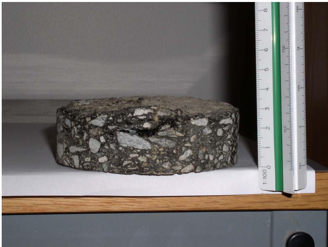
Figur 12 Eksempel på tynn og deformert prøve (uegnet for videre testing).
