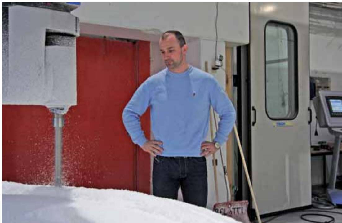
Fresar: Endre Kvalheim og bedrifta Easy Form leverer til verdas største vindmølleprodusent. Her fresar maskina fram grunnlaget til ei form som skal nyttast til å støype den delen som sit ytterst på navet til vindturbinane.
